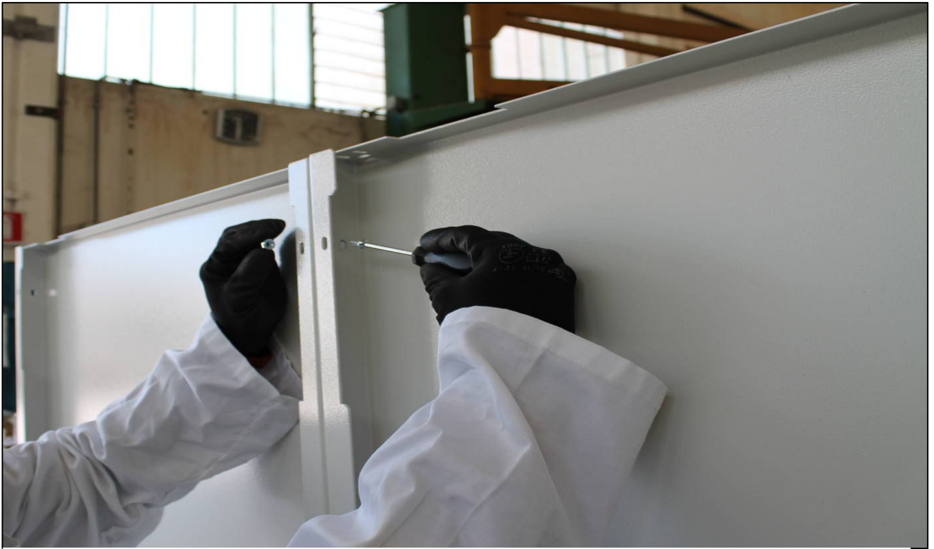
5) Unire i pannelli tra loro nei tre punti (alto, basso e centrale) 5) Joining the panels together in the three points (top, bottom and middle)
